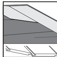
Für die zweite Reihe schneiden Sie die Fliese auf die erforderliche Länge, verbinden Sie die Feder der neuen Fliese mit der Nut der bereits platzierten Fliese im 30° Winkel und legen die neue Fliese ab, dabei halten Sie das oben abgebildete Muster ein.
