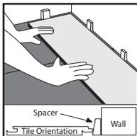
Die erste Fliesenreihe sollte an der Wand entlang verlegt werden, mit der Feder zur Wand, von links nach rechts, dabei werden die Fliesen bei Bedarf auf die richtige Breite geschnitten.
