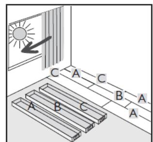
Beginnen Sie mit der Verlegung gemäß Verlegeplan in der linken Ecke der längsten Raumwand. Die Click-Verbindung an der Stirnseite und der Längsseite zu der angrenzenden Wand ist abzuschneiden. Dies gilt auch bei folgenden Elementen, die unmittelbar an Wände grenzen.
