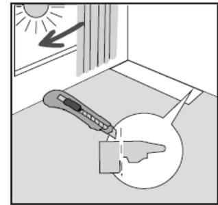
Halten Sie bereits bei der ersten Verlegereihe und anschließend zu allen weiteren aufsteigenden Bauelementen (Wände, Säulen, Heizungsrohre etc.) mindestens 10 mm Abstand. Dies kann durch Abstandskeile bewerkstelligt werden. Nichtbeachtung führt zu einem eingespannten Zustand der schwimmenden Konstruktion und führt zu Aufwölbungen im Bodenbelag und in der Folge ggf. zur Zerstörung der Click-Verbindung.
