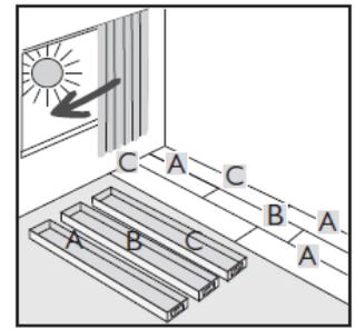
Schneiden Sie die Elemente der letzten Reihe auf Maß. Verfahren Sie bei der Verriegelung der Stirnseiten wie gehabt. Eine dauerhafte Verbindung der ggf. schmalen Endreihe erreichen Sie durch die Verwendung eines Kaltschweißmittels Typ A. Die Verriegelung der Längsseite kann mit Hilfe von Zugeisen oder ähnlichen Hilfsmitteln unterstützt werden. Achten Sie darauf, dass keine dauerhafte Verbindung zum Unterboden entsteht. Beachten Sie hierbei auch den einzuhaltenden Randabstand von 10 mm.
