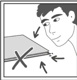
Während der Verlegung die Elemente aus mindestens drei oder mehr Paketen gleicher Charge mischen und auf Materialfehler überprüfen. Elemente mit sichtbaren Materialfehlern dürfen nicht verlegt werden.
